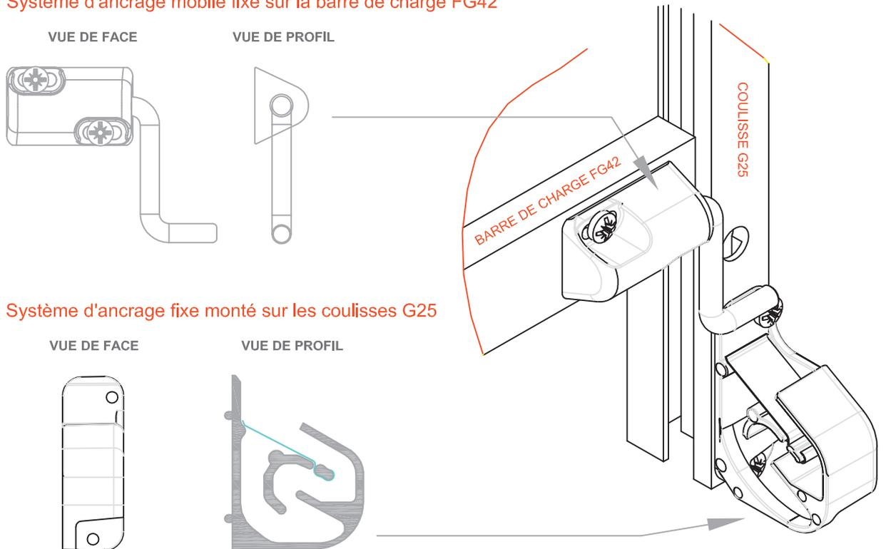
Système d'ancrage fixe monté sur les coulisses G25
